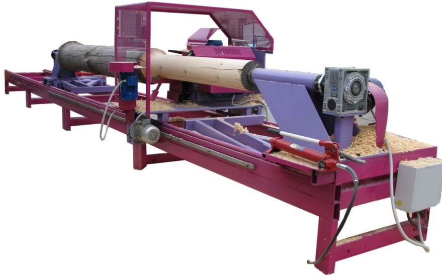
Станок оцилиндровочный «Терем8000В» предназначен для изготовления оцилиндрованного бревна. В виде сырья можно использовать помимо пиловочника, брус, брёвна с повышенной кривизной, сучковатостью и конусностью.
